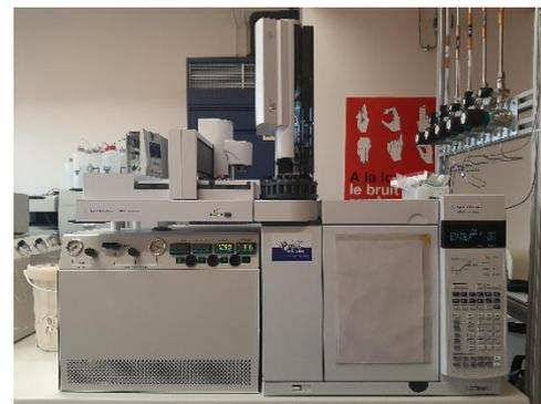
**Photo 1 :** Chromatographie en phase gazeuse couplée à un module de combustion
