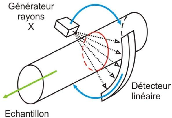
Cette technologie appliquée au matériau bois permet de **multiples applications** : étude de la croissance des arbres, cartographie de la densité interne, répartition de la teneur en eau, mesure de la nodosité ...
